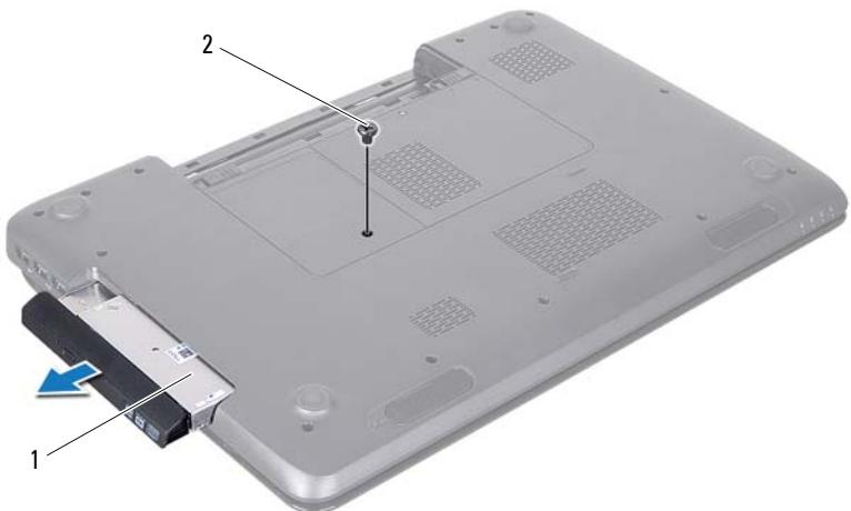
1 блок оптического дисковода
